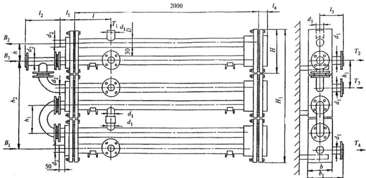
**Рис. 6. Водоподогреватель блочного типа по ТУ 400-28-132-90**
