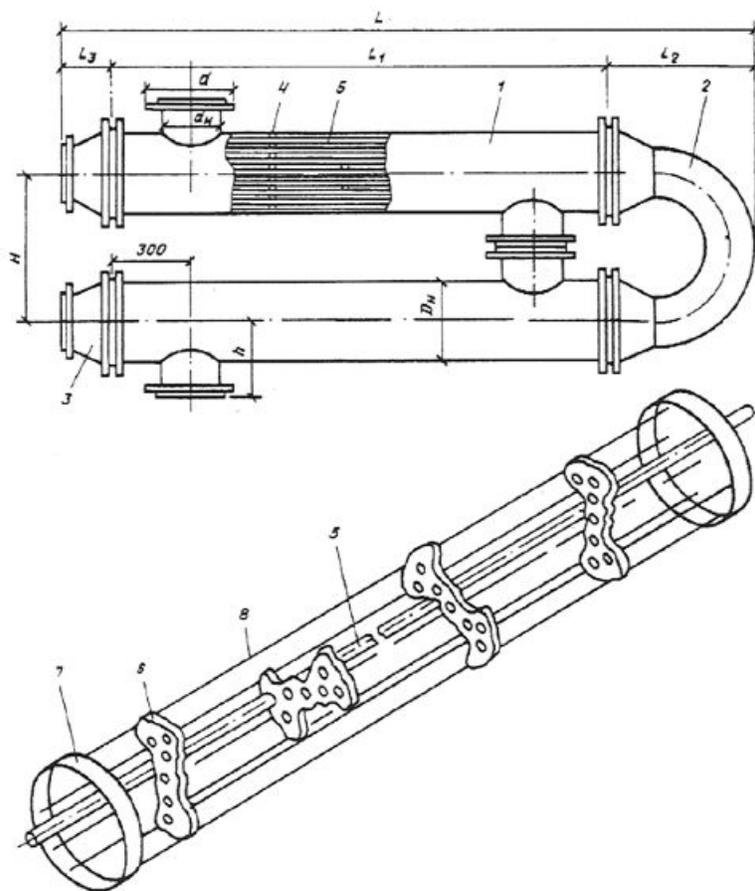
**Рис. 2. Конструктивные размеры водоподогревателя**
