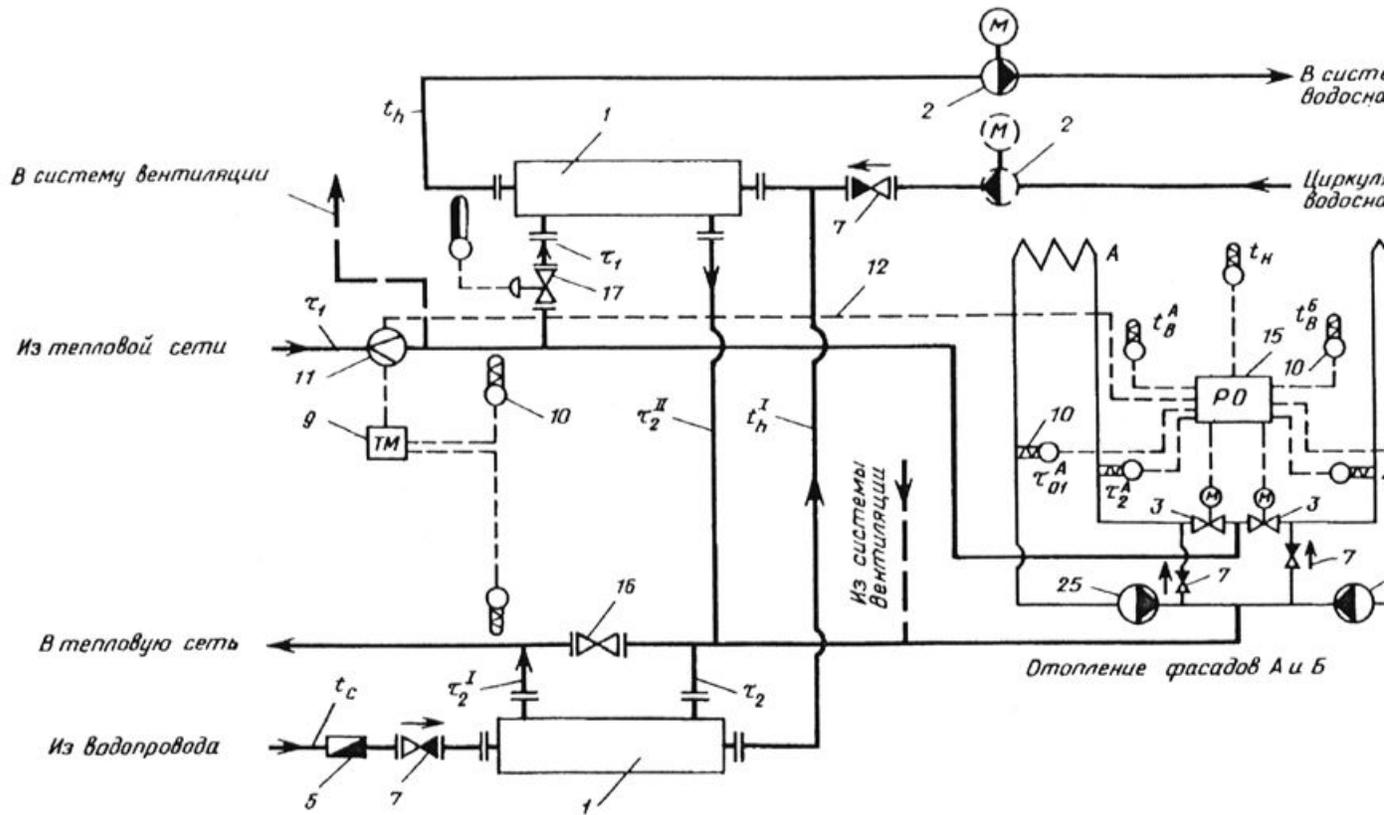
**Рис. 6. Двухступенчатая схема присоединения водоподогревателей горячего водоснабжения в ИТП с зависимым присоединением систем отопления и пофасадным автоматическим регулированием расхода теплоты на отопление**
