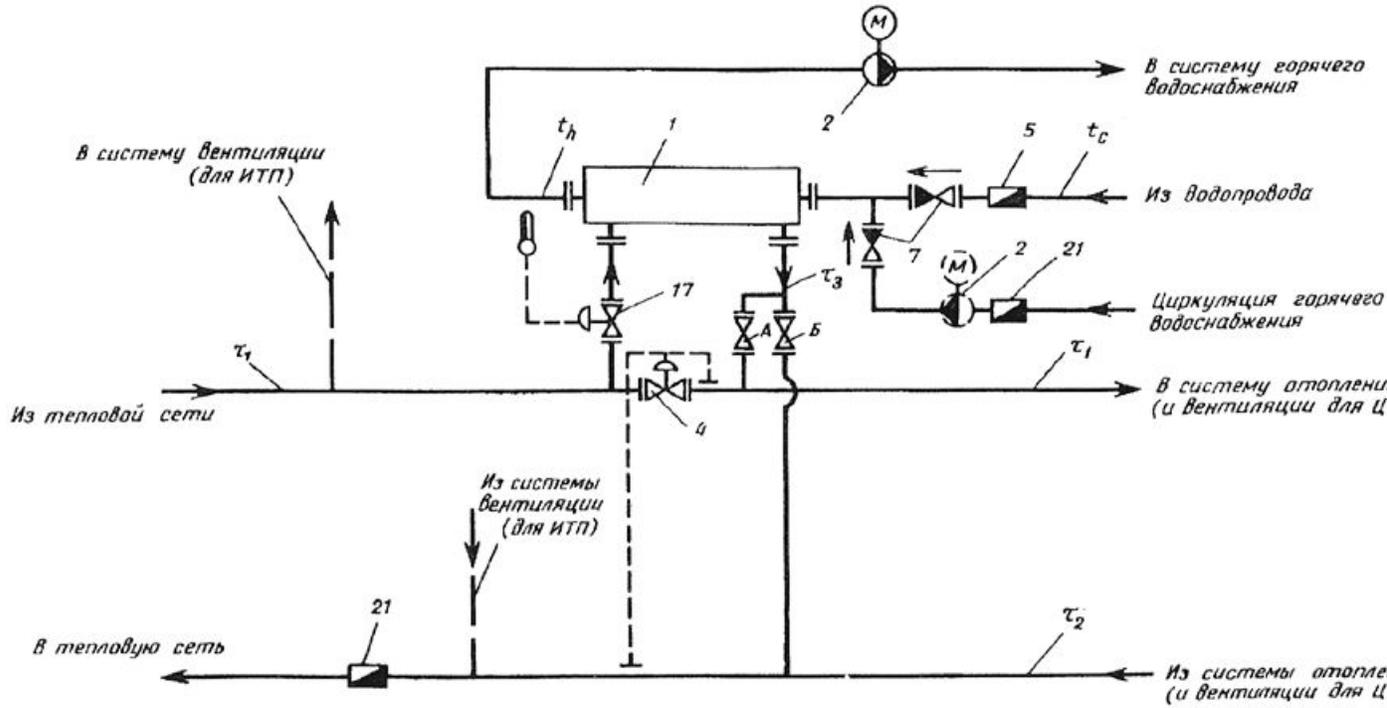
**Рис. 7. Одноступенчатая схема присоединения водоподогревателей горячего водоснабжения с зависимым присоединением систем отопления при отсутствии регуляторов расхода теплоты на отопление в ЦТП и ИТП**
