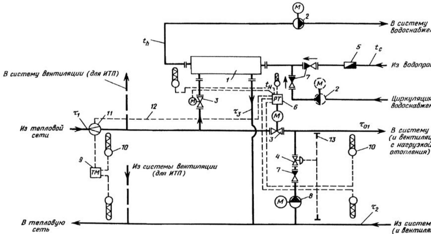
**Рис. 1. Одноступенчатая система присоединения водоподогревателей горячего водоснабжения с автоматическим регулированием расхода теплоты на отопление и зависимым присоединением систем отопления в ЦТП и ИТП**
