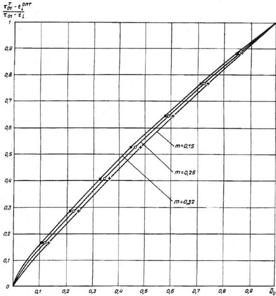
**Рис. 2. Графики изменения температурного критерия системы отопления по температуре воды в подающем трубопроводе  $\left(\frac{T_{01} - t_i^{01}}{T_{01} - t_i}\right)$  для различных значений показателя степени  $m$  и при постоянной циркуляции теплоносителя в системе**
