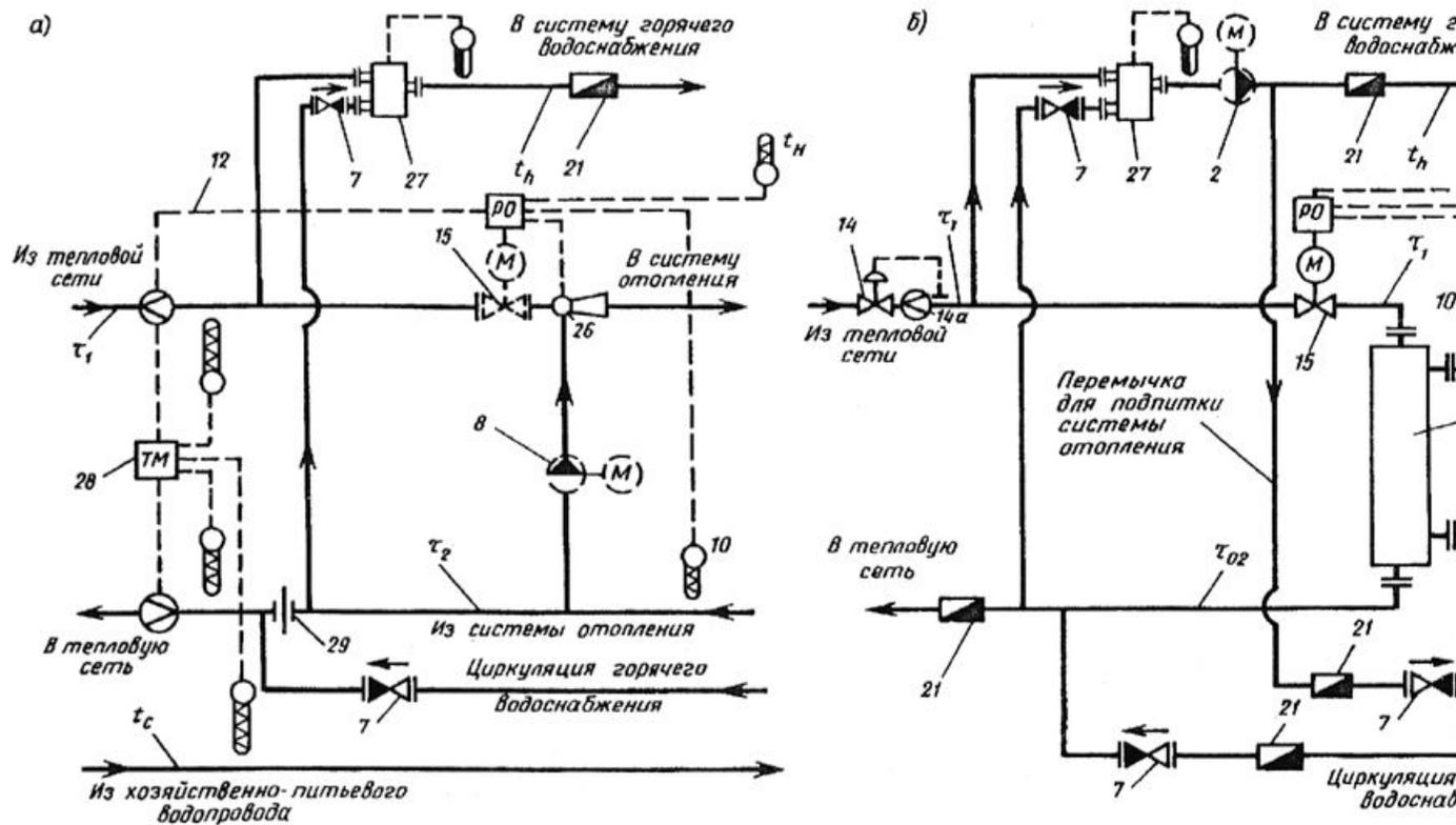
**Рис. 9. Схемы присоединения систем горячего водоснабжения и отопления в ИТП при зависимом (а) присоединении системы отопления через элеватор (пунктиром - с циркуляционным насосом) с учетом теплоты по тепломеру и независимом (б) - с учетом теплоты по водомеру**
